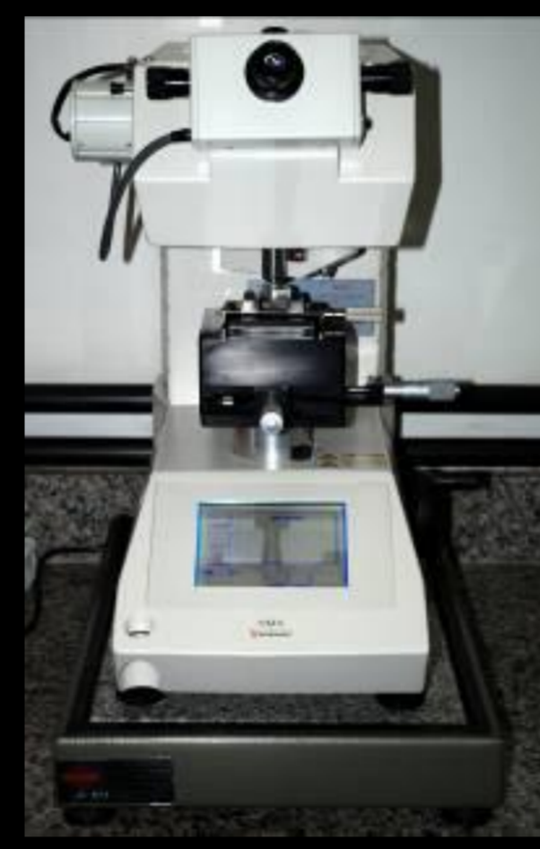
Fig1: Microdurômetro (HMV-2000 Shimadzu, Tokyo, Japão); Edentações na superfície da resina.
