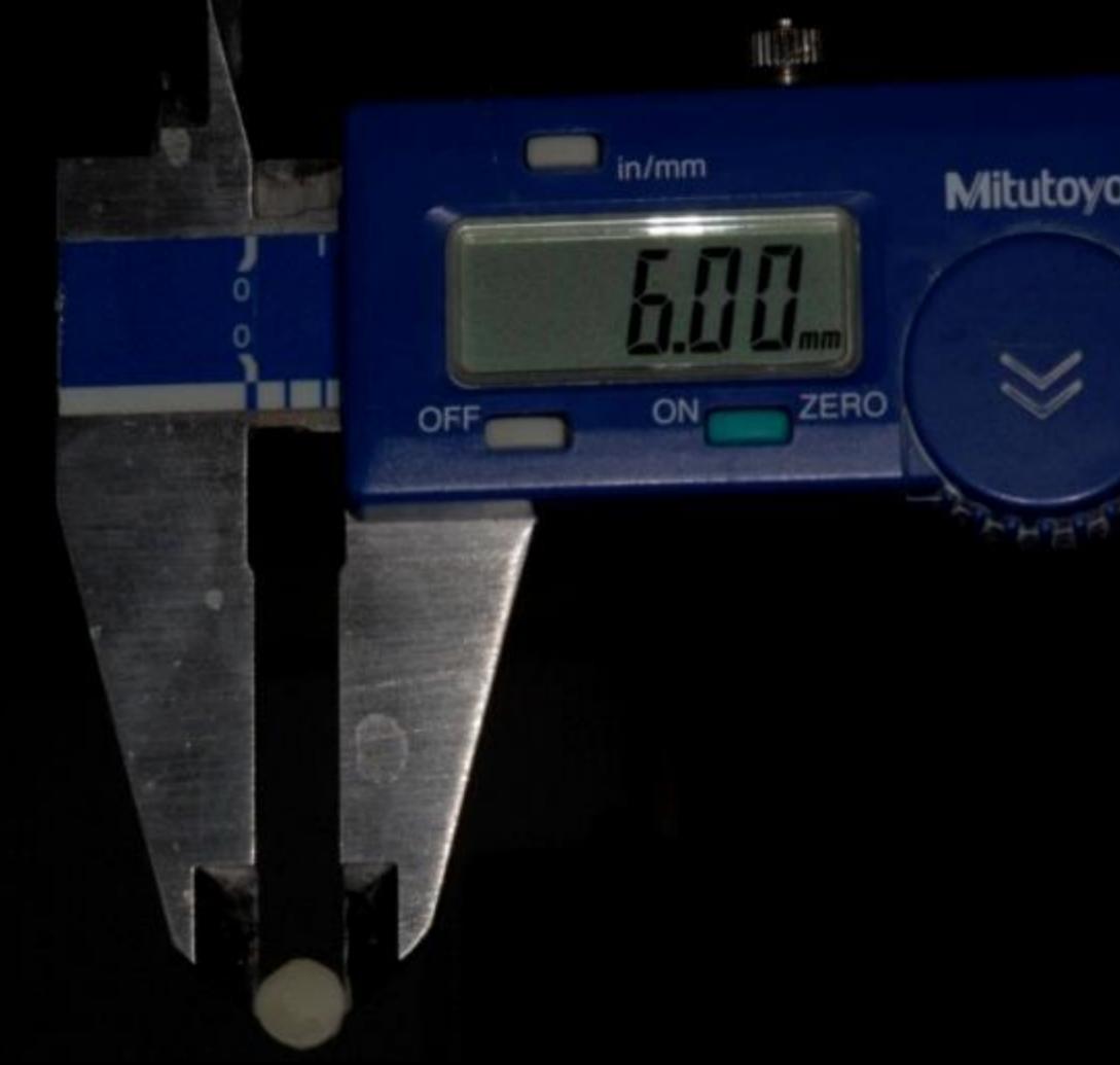
Fig2: Paquímetro; Aferições de altura e diâmetro para cálculo de volume.
