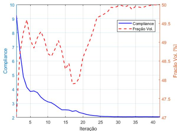
Figura 6: Compliance e Fração Vol. a cada iteração
