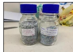
Figura 1 - microplásticos após trituração
