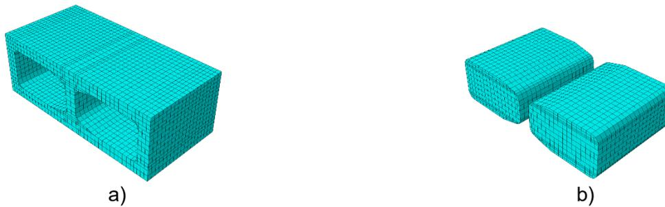
**Figura - 1** a) Blocos vazios de concreto modelados no ABAQUS b) O vazio (ar) modelado no ABAQUS.
