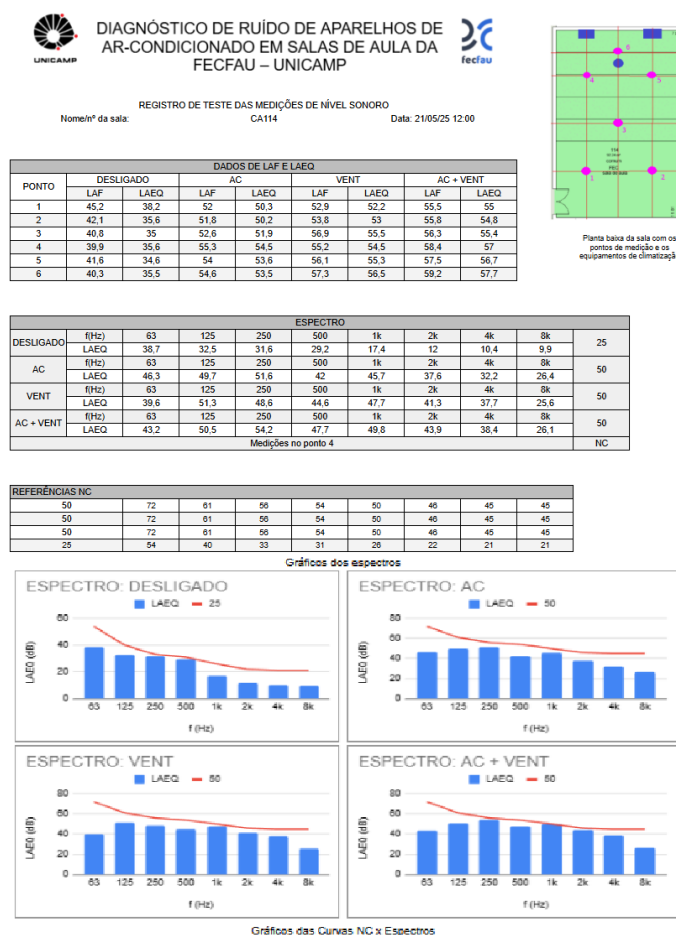
Figura 2 – Registro da coleta de dados de medição, contendo espectros sonoros e esquema com pontos de fonte e microfone de uma sala de aula avaliada.
