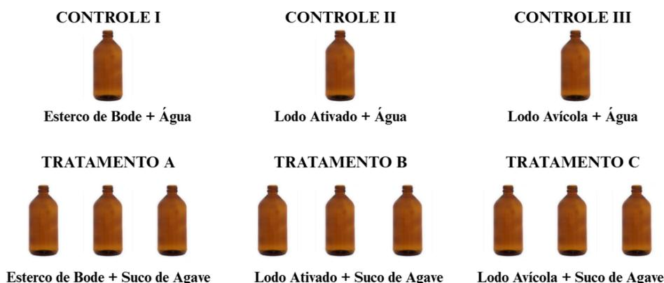
Figura 2: Avaliação de diferentes inóculos na produção de biogás de agave
