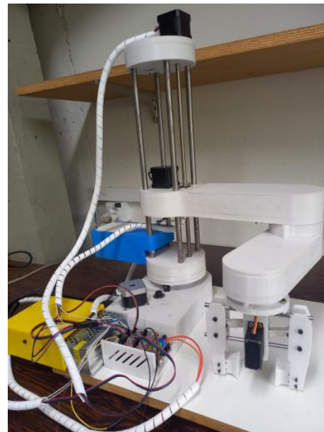
Figura 3: Primeiro protótipo do braço robótico construído para o projeto.
