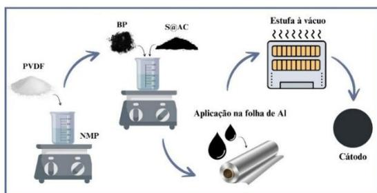
**Figura 2.** Etapas presentes no preparo da tinta. São representadas a dissolução dos materiais, o aquecimento, a aplicação em folha de Al, a secagem na estufa e o corte dos cátodos
