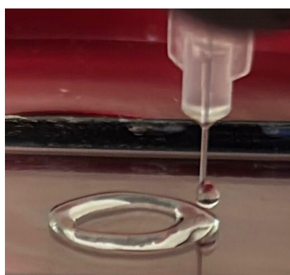
Figura 3: Hidrogel de alginato (concentração 6% em massa) gotejando no bico em repouso.
