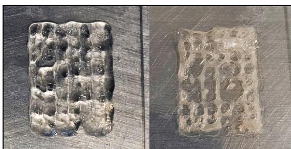
Figura 4 - Na esquerda, amostra impressa com uma camada de alginato sobre uma camada de quitosana; Na direita, a amostra após ser liofilizada, não parece quebradiça como as amostras com argila e pode ser manipulada sem quebrar.
