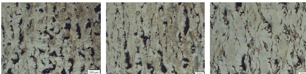
**Figura 3.** Imagem de microscopia óptica das microestruturas das Ligas de Ti-Cu originadas com 25% da potência nominal do laser, aproximadas em 50 vezes, com pouca, média e alta taxa de cobre, respectivamente. **Fonte:** Durães (2025).
