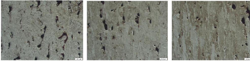
**Figura 4.** Imagem de microscopia óptica das microestruturas das Ligas de Ti-Cu originadas com 35% da potência nominal do laser, aproximadas em 50 vezes, com pouca, média e alta taxa de cobre respectivamente. **Fonte:** Durães (2025).
