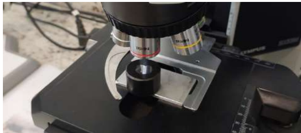
Figura 3: Amostra com SiC-0,5% embutida em resina.
