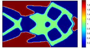
Figura 7 – Topologia otimizada com dois materiais sob restrição ambiental ( $\phi_{\text{target}} = 1,4$ )
