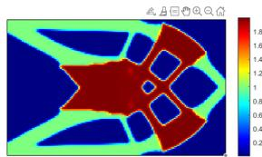
Figura 4 – Topologia otimizada com dois materiais (sem restrição de pegada de carbono)
