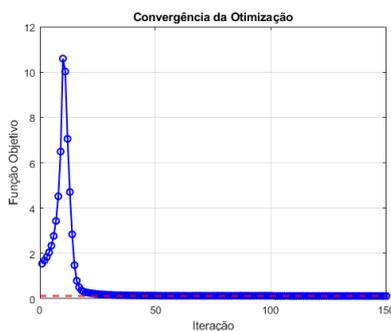
Figura 5 – Evolução da *compliance* com dois materiais (sem restrição ambiental)
