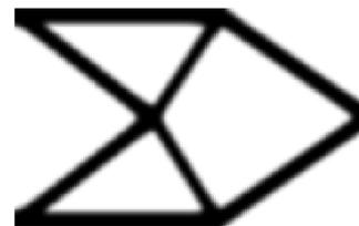
Figura 3 – Topologia otimizada utilizando apenas um material
