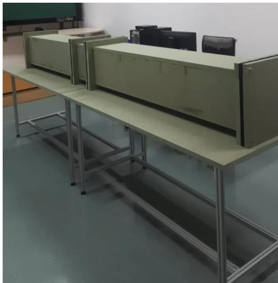
*Figura 5 - Tubo de Impedância Concluído Contendo Quatro Partições sendo: a Primeira Parte o Caixa do Amplificador Sonoro, a Segunda e a quarta parte o corpo do tubo onde Serão Inseridos os Microfones e a Terceira Parte se Trata do Suporte de Amostra.*
