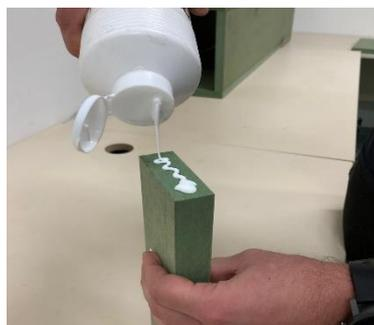
Figura 4 - Aplicação de Cola nas Emendas do Tubo a Fim de Garantir uma Maior Vedação.
