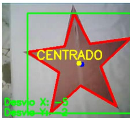
Figura 3 - Visualização ao vivo da detecção e marcação do centro do alvo – fonte: do próprio autor
