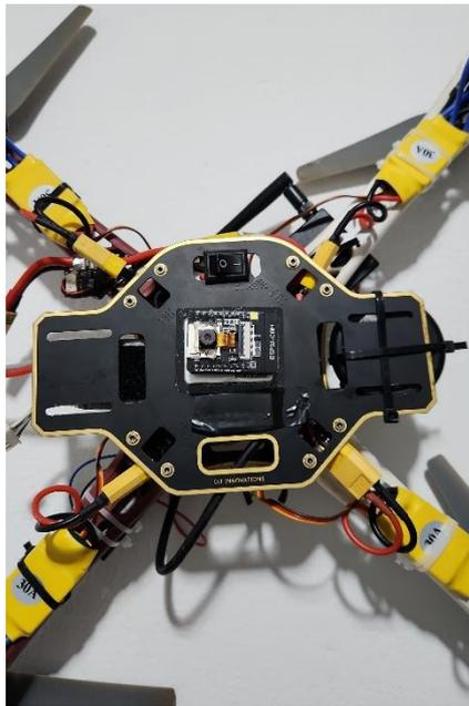
Figura 1 - Protótipo do drone com a ESP32-CAM – fonte: do próprio autor
