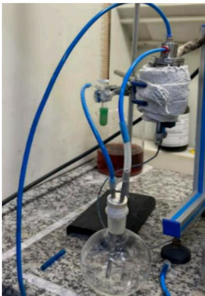
Fig. 1. Sistema batelada para captura de CO<sub>2</sub>.
