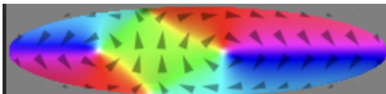
Figura 6: Configuração de mínima energia após relaxação, evidenciando a formação de estruturas tipo vórtices nas extremidades do nanodisco elíptico ao longo do eixo maior.
