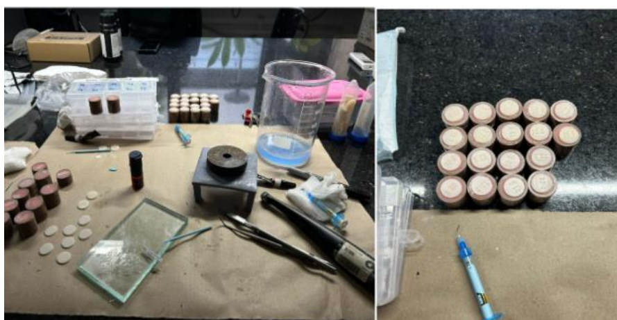
Figura 1: A – Confecção das amostras em RI 3D. B – Amostras embutidas em tubos de PVC.
