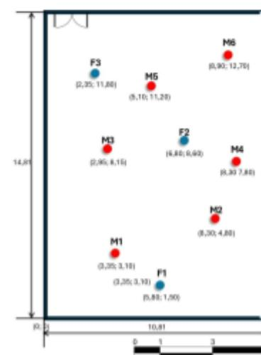
Figura 2 - Posições de fonte e microfone na sala 111. Fonte: Autoria própria
