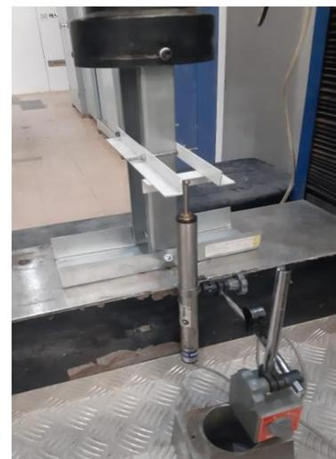
Figura 2: Amostra submetida à máquina de compressão e ao transdutor.
