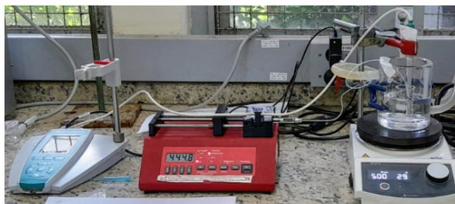
Figura 3. Sistema montado para as análises de condutividade.
