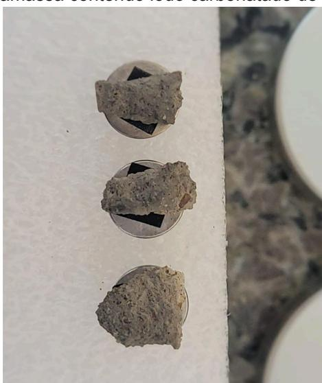
Tabela 01: Composição dos traços para produção das argamassas com substituição parcial de Cimento Portland CPV por lodo carbonático em gramas.
