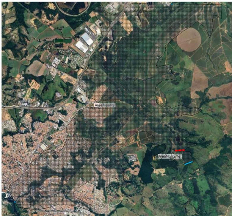
Figura 3 - Localização dos elementos de geometria do projeto (em azul, as linhas de condição de contorno; em vermelho, a linha da barragem; quadriculadas, as áreas de simulação 'AreaMontante' e 'AreaJusante')
