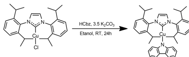
Figura 1: Síntese do complexo [Cu(IPr)Cbz] pelo método de Tzouras et. al.
