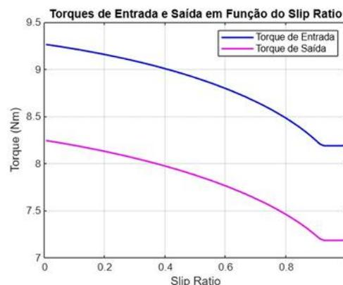
Figura 3: Ilustração da variação do torque com base no slip ratio
