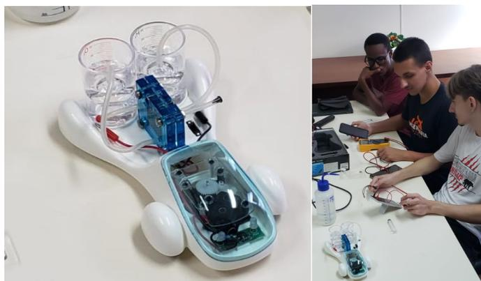
Figura 1 – Carrinho movido a hidrogênio usado no projeto para produção de hidrogênio verde.
