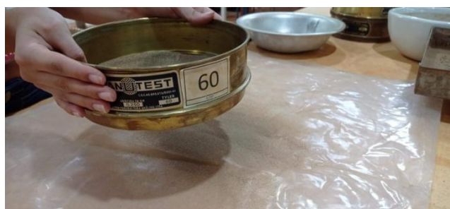
Figura 4. Peneiramento de amostras do leito do rio no laboratório de solos.
