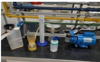
Figura 3. Equipamentos para a filtragem das amostras líquidas no laboratório de saneamento.
