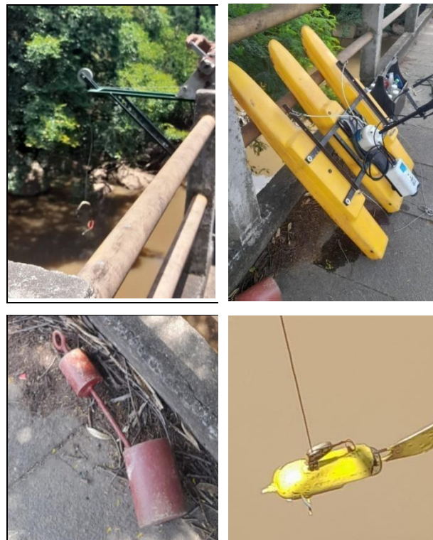
Figura 2. Suporte e guincho, medidor de vazão ultrassônico, draga Petersen e DH 48 respectivamente.
