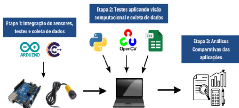
Figura 2 – Diagrama do sistema implementado – fonte: Coletânea do autor
