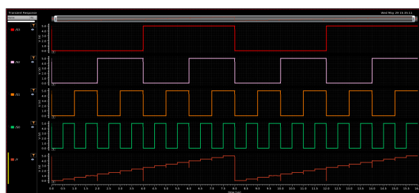
Figura 6 – Curva característica do Multiplexador 16x1 pelo software Cadence Virtuoso®.
