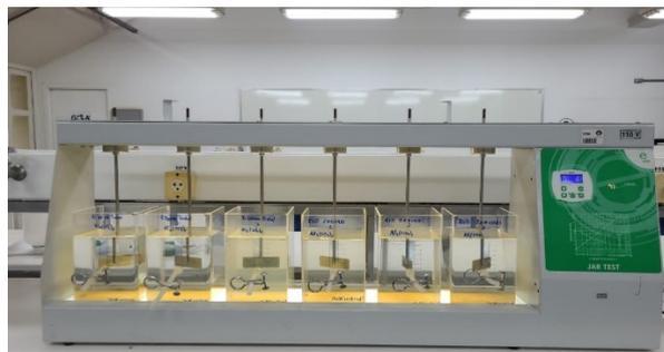
(b) - Término do ensaio: Após a decantação.
