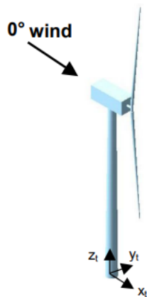
Figura 1 - Sistema de Coordenadas Torre (Base)
