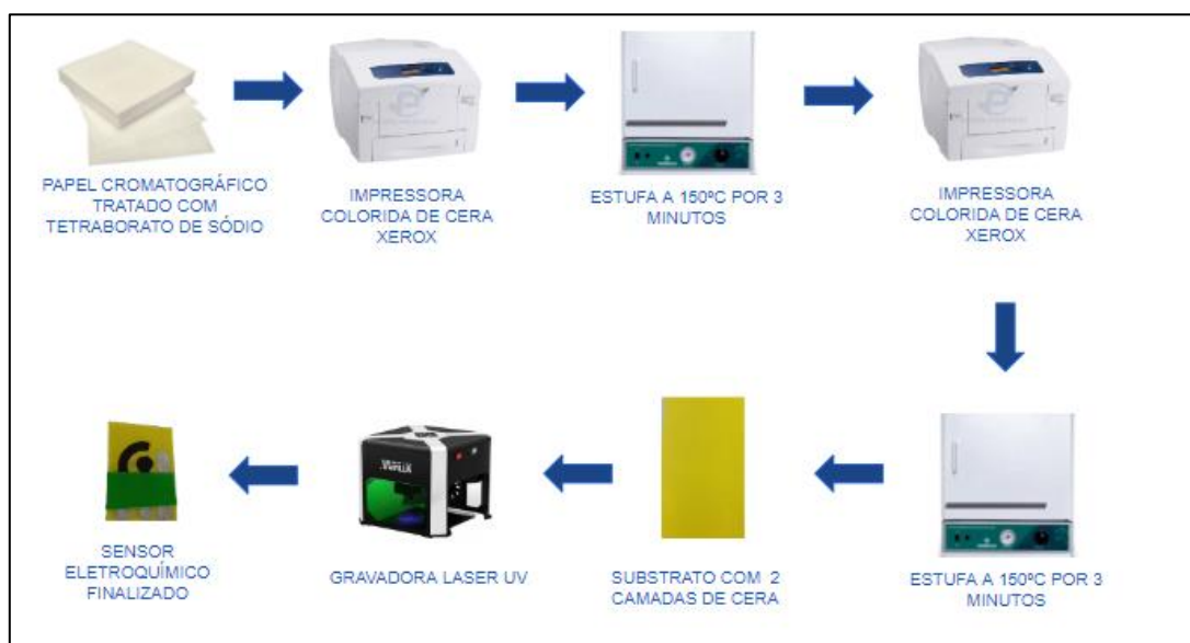
Figura 1: Esquematização da fabricação do sensor eletroquímico miniaturizado portátil. O papel tratado com tetraborato de sódio é levado à impressora de cera colorida Xerox para impressão das 2 camadas de cera amarela. Em seguida, é feita a gravação do layout dos eletrodos na gravadora a laser. Por fim, os contatos elétricos são pintado com tinta de Ag e o eletrodo de referência (pseudo-referência) é pintado com a tinta de Ag/AgCl.
