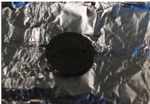
**Imagem 2:** Pastilha de 1,5 mm espessura, obtida após compactação de pó de titânio e microalgas com granulometrias  $>0,3$  mm, em proporção mássica de 80% e 20% respectivamente, sob pressão entre 7 e 8 toneladas.
