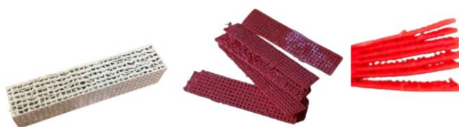
Figura 3: Falhas observadas nas estruturas impressas em ABS pelo método FDM
