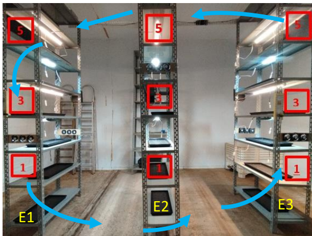
Figura 1: (a) Câmera para experimento de microverdes com estantes identificadas em três alturas de prateleiras e três repetições. Em azul, a movimentação do ar dentro da câmara. Em amarelo, a identificação das estantes. (b) Mapa de distribuição de densidade de fluxo de fótons fotossintéticos (PPFD), medida a 30 cm de distância das lâmpadas.
