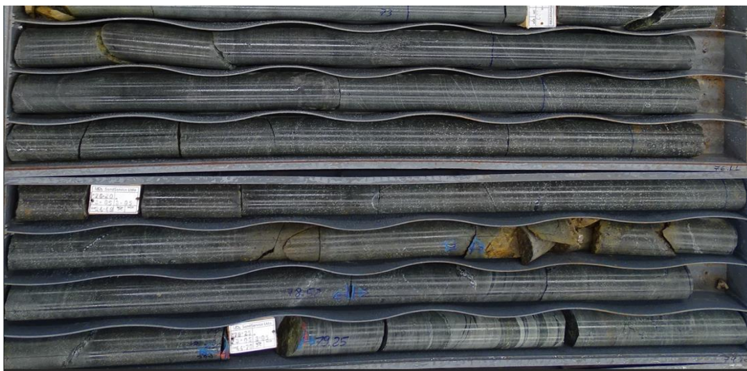
Figura 2: Testemunho de sondagem do metadiabásio interceptado em profundidade.
