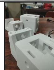
Figura 4 - Peças maiores impressas para a montagem da máquina de ensaios mecânicos.
