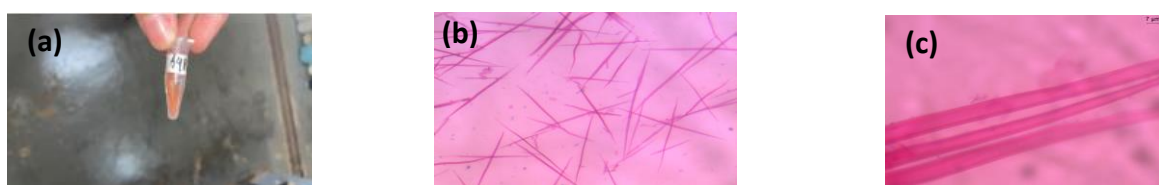
Figura 2 – (a) Eppendorf com amostra; (b) fibras sob aumento de 4 vezes; (c) fibras sob aumento de 40 vezes.
