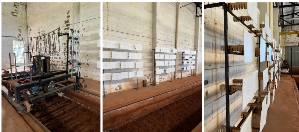
Figura 1-3 – Chassi do pulverizador e placas de plástico para simular o volume foliar da aplicação – fonte: De autoria própria.
