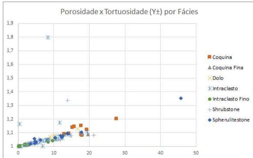
Figura 4. Gráfico com Porosidade (%) na abscissa e tortuosidade na ordenada. Corresponde à direção \pm Y
