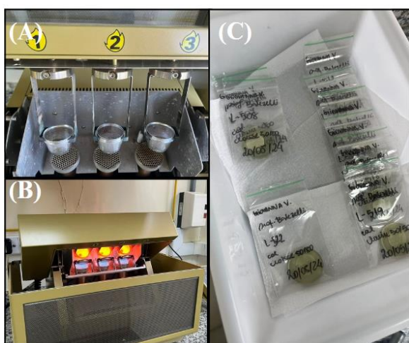
Figura 5: (A), (B) Distribuição das amostras em frascos (cadinho) que foram submetidos a temperaturas de fusão do sólido para a formação de discos (C)
