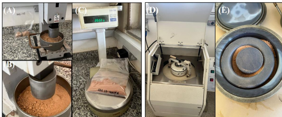
Figura 4: (A) Processo de britagem da amostra ARA 07 na qual era disposta no recipiente do equipamento e triturada até ficar equivalente à figura (B). (C) Pesagem da amostra ARA 03 - Contato na balança pós britagem. (D), (E) Processo de moagem da amostra ARA 07 efetuado após sua britagem.
