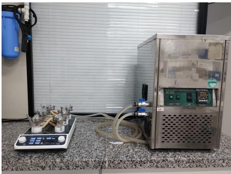
**Figura 1.** Agitador magnético acoplado ao banho termostatzado
