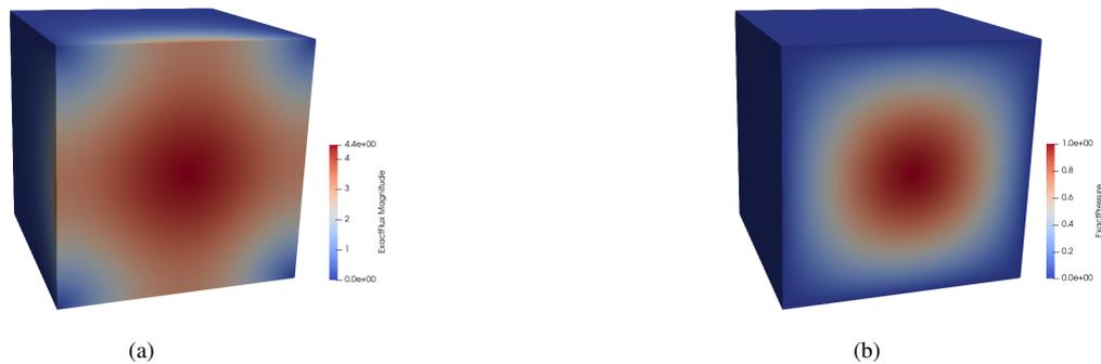
Figura 1: Representação da solução analítica do fluxo (a) e da pressão (b) para o problema de Darcy.
