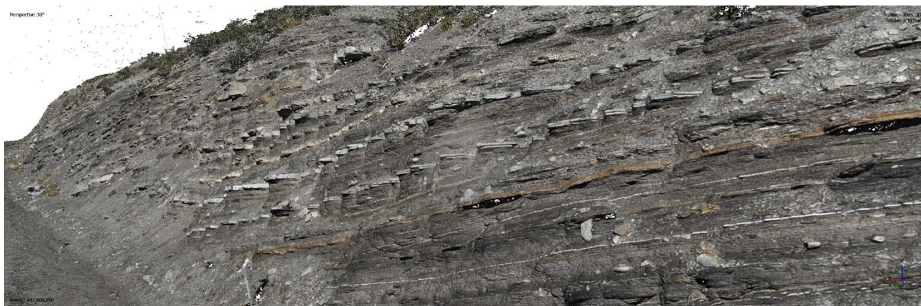
Figura 3 – Nuvem densa de pontos do Modelo Virtual de Afloramento otimizado, destacando a geometria do afloramento a partir de sua topografia. As cores do modelo derivam das fotografias, resguardando os aspectos visuais do afloramento real.
