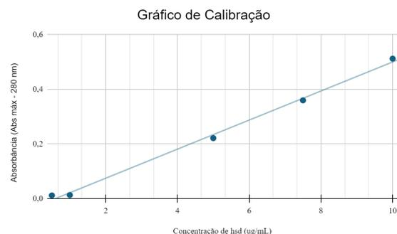
**Figura 5:** Curva de calibração usada para a quantificação da Hsd nas nanopartículas.
