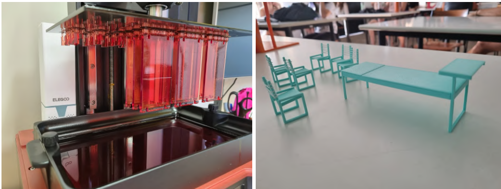
Figura 01: Impressora 3D em funcionamento e exemplo de protótipo impresso de mobiliário
