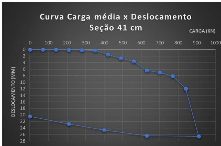
Figura 4 – Prova de carga estática à tração.
