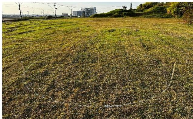
Figura 1 – Foto do procedimento feito para encontrar a orientação de um edifício. Vê-se: círculo de cal com uma estaca central, mais duas estacas com as marcações da manhã e da tarde. Fonte: foto autoral.
