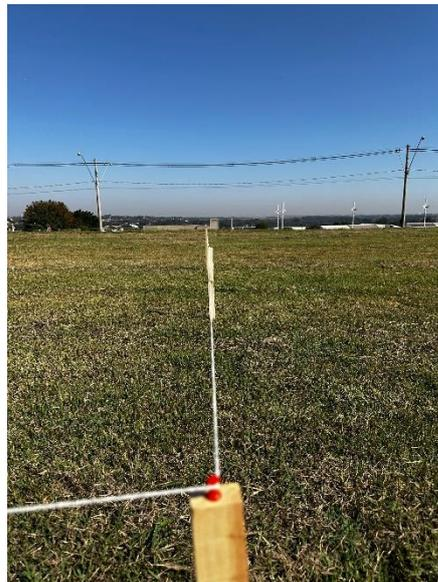
Figura 2 – Foto do estabelecimento de uma linha reta. As diversas estacas cravadas no terreno obedecem à direção da corda. Fonte: foto autoral.
