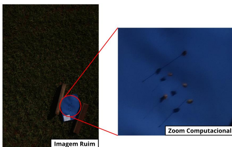
FIGURA 4. Exemplo de imagem obtida nos testes considerada ruim, e ao lado zoom computacional mostrando a falta de nitidez dos insetos da imagem
