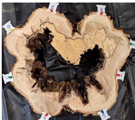
Figura 2 – Exemplo de disco de ligustro japonês polido, demonstrando cavidade e biodeterioração com marcações de pontos de contorno para malha de difração de 8 pontos.
